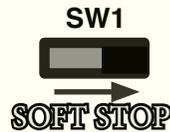
SW1 Cambiar a la derecha para activar la configuración (vuelva a colocar el interruptor a la izquierda después de completar el ajuste)
