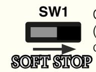
Cambiar a la derecha para activar la configuración (vuelva a colocar el interruptor a la izquierda después de completar el ajuste)
