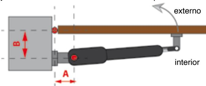
■ **A**= Según la carga del motor y en el centro de la bisagra de la puerta, esta medición debe permitir que la puerta se abra a 90°. Coloque las placas de fijación del motor de modo que permitan la apertura geométrica de la puerta a 90°.
