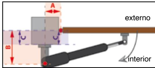
■ **A** = distancia (en sección, en el eje transversal) entre el eje de las bisagras de la puerta (V) y el pivote sobre el que gira el actuador (K). El usuario puede elegir esta distancia respetando los límites específicos para su modelo de motor. Es aconsejable elegir un tamaño similar al tamaño B. En general: una A más grande permite un mayor ángulo de apertura.
