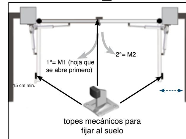
1) **¡ADVERTENCIA! ANGULO DE INCIDENCIA.** Para asegurar un sellado perfecto de la compuerta al cerrar, es necesario instalar el actuador en un ángulo de incidencia con respecto a la compuerta cerrada. De esta manera, el actuador mantendrá la puerta firmemente cerrada.
