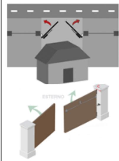
Si la puerta se abre hacia el exterior de la propiedad (ver página 9). Verifique las dimensiones generales del motor y siga el esquema de fijación respetando los límites de medición A y B a continuación.
